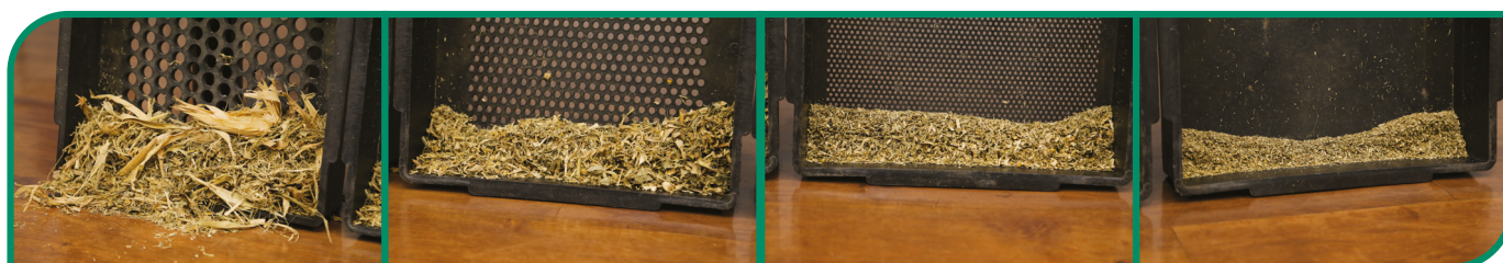
Figura 04. Resultado de avaliação de silagem de milho com uso do conjunto de peneiras Penn State. Em ordem: 19 mm; 8 mm; 4 mm e fundo.
